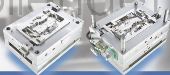
2-fach Spritzgießwerkzeug mit Heißkanal, 2 Schiebern, 2 Kernzügen und umspritzten Metalleinlegebuchsen
