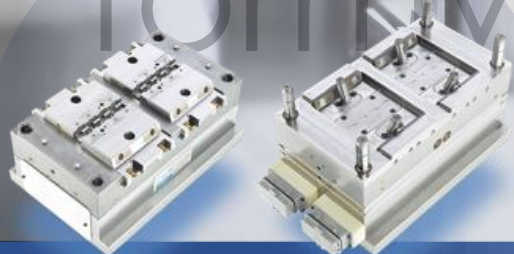
8-fach Spritzgießwerkzeug mit Heißkanal, 4 Schiebern, Zykluszeit kleiner 7 Sekunden
