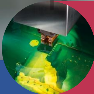
Senkerodieren mit Grafitelektroden für höchste Präzision
