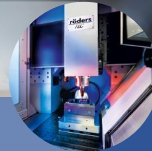
Hochgeschwindigkeitsfräsen der gehärteten Einsätze mit bis zu 42.000 U/min
