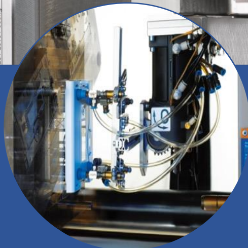
2-Komponenten-Fertigung mit Drehteller-Technik
